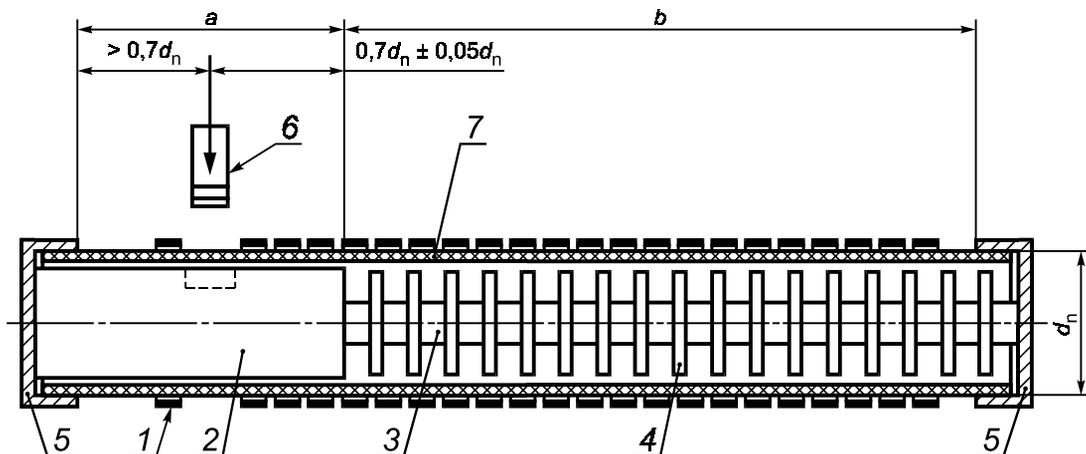
$a$  — зона инициирования;  $b$  — рабочая зона  $> 5d_n$ ; 1 — кольца наружной обоймы; 2 — наковальня; 3 — несущий стержень; 4 — декомпрессионные перегородки; 5 — заглушки; 6 — боек; 7 — испытуемый образец
